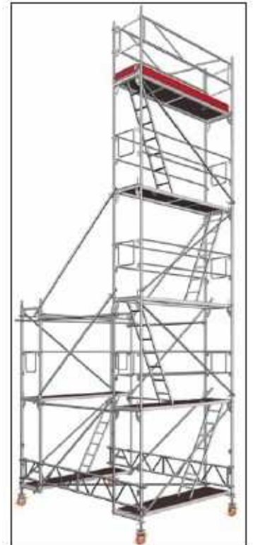
Att. 133: Divas sastatņu sekcijas savienotas ar režģa sijām, caurulēm un sakabēm
