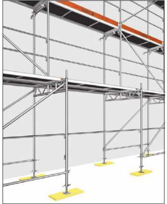
Att. 105: Portāla rāmju uzstādīšana
