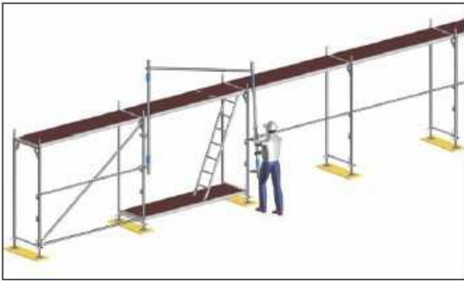
Att. 25: Papildus margas montāža piekļuves laidumā
