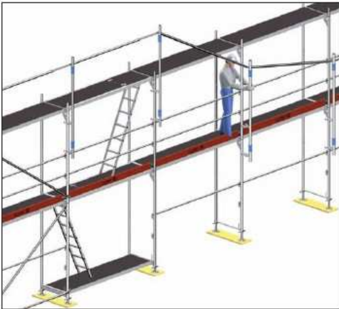
Att. 26: Papildus margas pielietojums sastatņu līmenī
