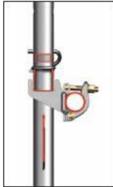
Att. 52: Sienas saites sakābes šķērsgriezums
