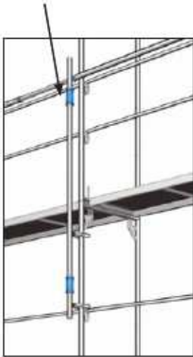
Att. 21 un 22: Papildus margas balsta piestiprināšana pie Speedy rāmja
