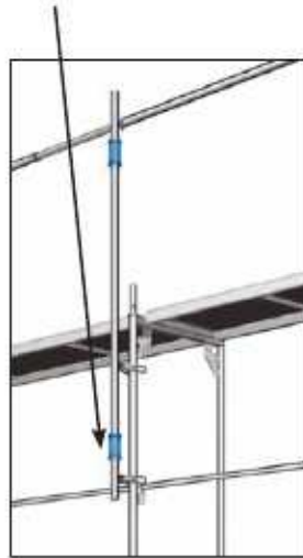
Att. 21 un 22: Papildus margas balsta piestiprināšana pie Speedy rāmja
