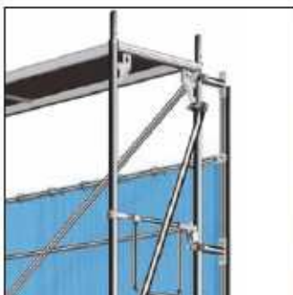
Att. 130: Keder pārklāju sistēmas montāžas piemērs
